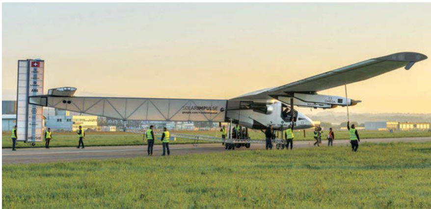
Solar Impulse 2: 72 Meter Spannweite und 17.000 Solarzellen
