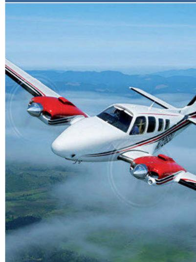
Die Beechcraft Baron erreicht eine Reisegeschwindigkeit von 370 km/h bei einer Reichweite von bis zu 2.700 km. Im Cockpit versorgt ein Garmin G 1000 mit zwei 10,5-Zoll-Bildschirmen den Piloten mit allen Daten, die Passagiere erwartet – neben der bequemen Einrichtung auch ein für die Größe unübliches Entertainment-System.
